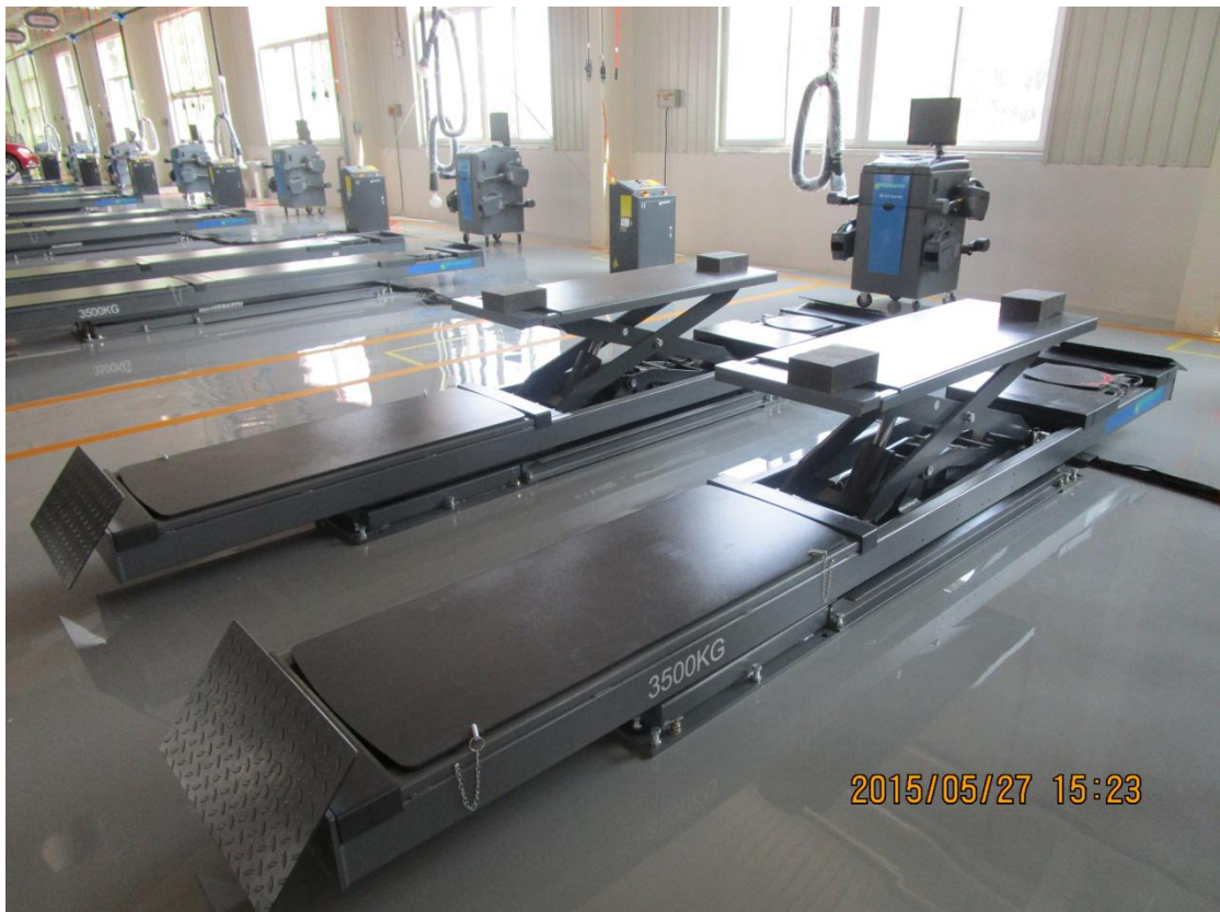
图 Figure 5 小剪的长度可以调整以便于安放举升垫块
