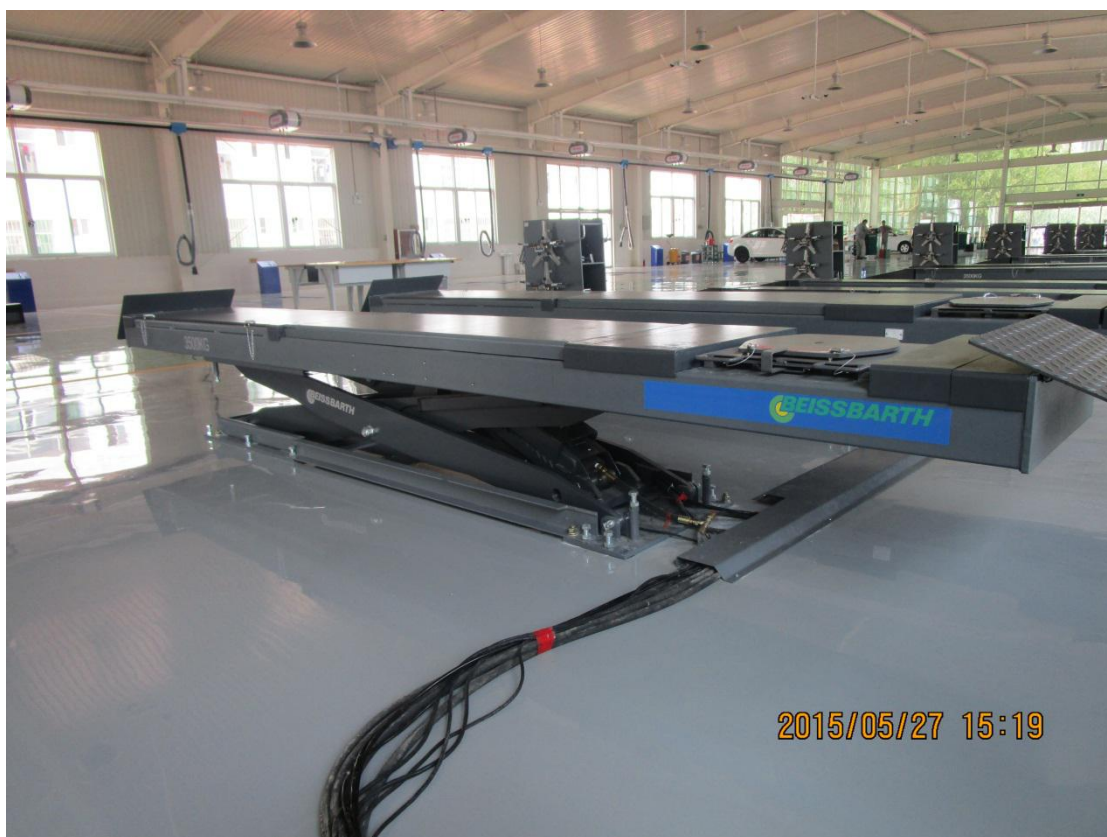
Figure 3 大剪最低落锁后高度 560mm 左右
